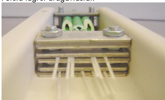
Andra lagret dragavlastat.
