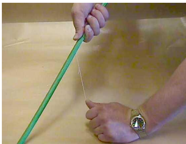
Skalning av kabel med hjälp av rivråd.
