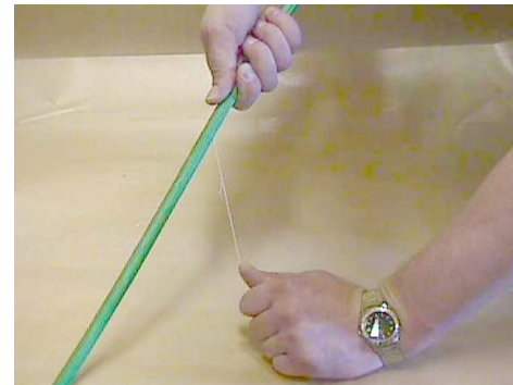
Skalning av kabel med hjälp av rivtråd
